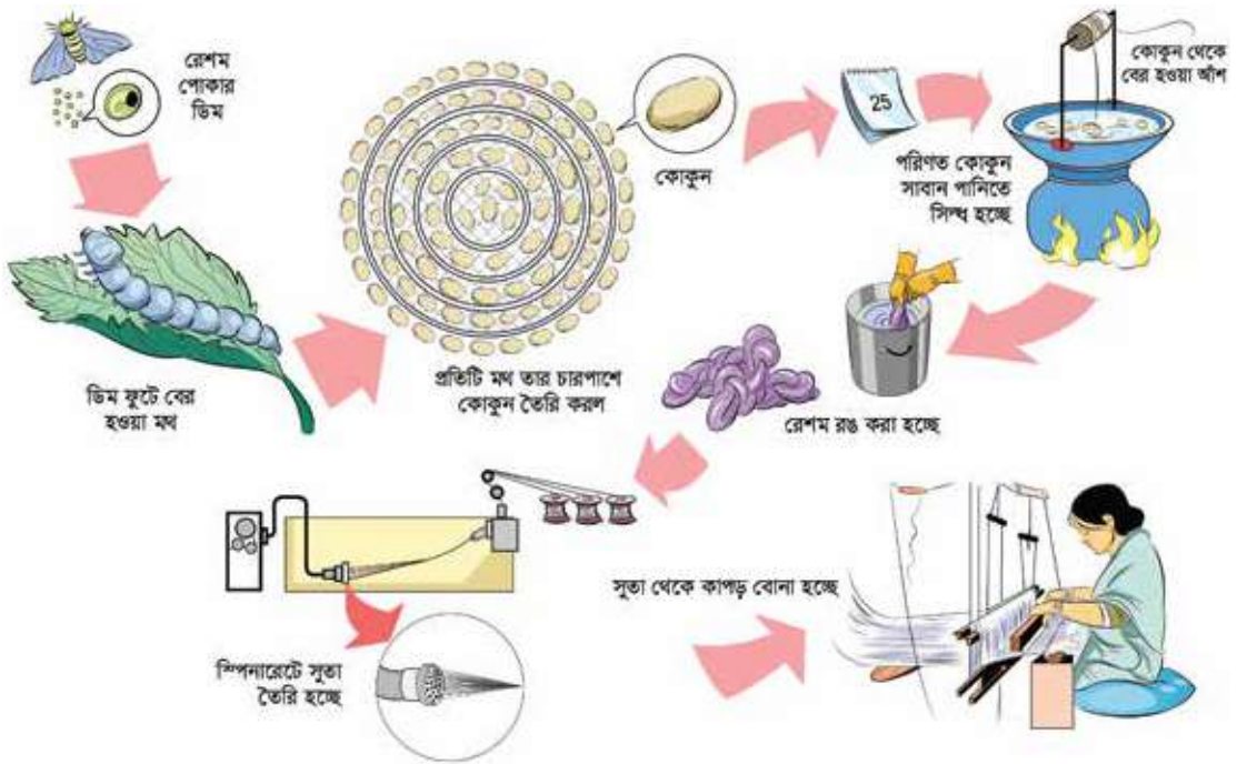
চিত্র ৬.০৪: রেশম তন্তু থেকে সূতা তৈরি
